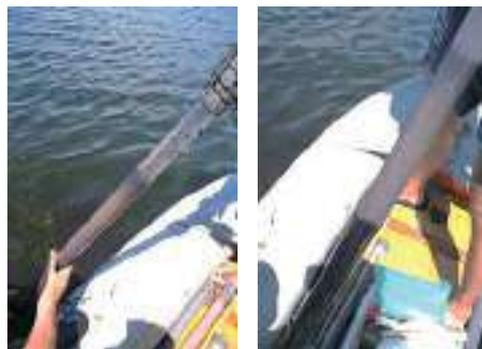
Aguja de toma de columna de sedimento: esta se desmontaba del dispositivo de hincia, y se confinaban el sedimento y el agua mediante tapones en ambos extremos
