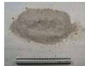
Muestra de material residual de la perforación sobre roca sana
