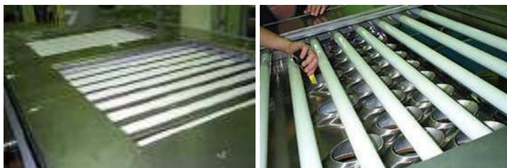
Vista general del reactor de desinfección con lámparas UV no inundadas: prototipo B.
