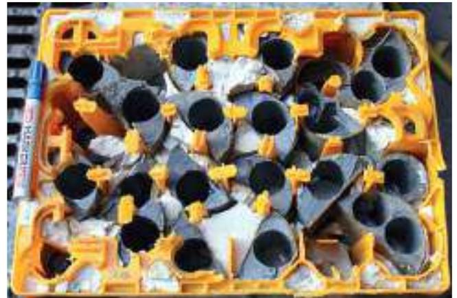
A. Obtención de probetas (*subcoring*) a partir de una serie de mitades de testigo de 4" de diámetro (*full cores*)
