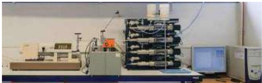
C. Equipo para la medida de la permeabilidad en rocas de baja o muy baja permeabilidad, empleando métodos estacionarios o transitorios
