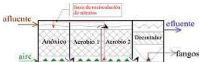
Figura 1. Proceso de lecho aireable sumergido (LAS-NITRO)
