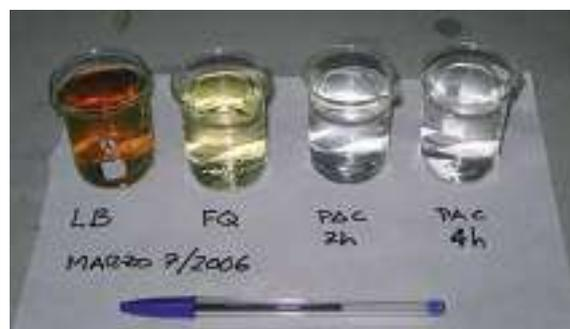
De izquierda a derecha se observa el aspecto del lixiviado: bruto (LB), después del tratamiento físico-químico (FQ), y después de adsorción con carbón activo durante 2 y 4 horas (PAC 2h y PAC 4h)
