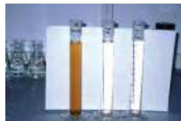
Izq. a der.: Lixiviado bruto, tras precipitación con cal y tras precipitación con cal más adsorción con carbón activo en polvo
