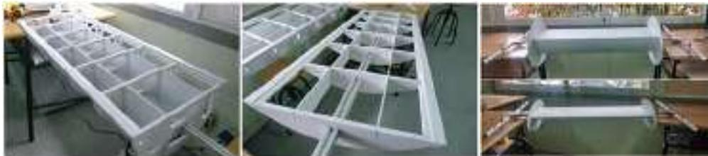
Las barras de aluminio tienen acanaladuras que facilitan el montaje del modelo sujetándose mediante barras o muelles a las células de carga. Los modelos se realizan con placas de material PVC, de 0.5 mm para el contorno exterior y 10 mm para las costillas. Una barra de acero de 8 mm de diámetro se utiliza para desplazar el centro de gravedad a la altura de la barra central de aluminio.
