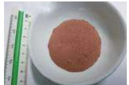
*Imagen del material final listo para realizar las granulometrías*
