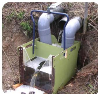
Sistema de medición de caudales compuesto por: vertedero triangular y sonda de nivel
