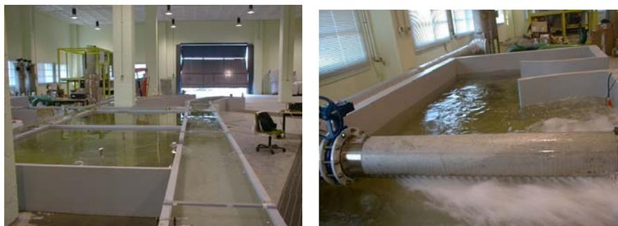
Figura 19. Planta de ensayos hidráulicos. Modelos reducidos
