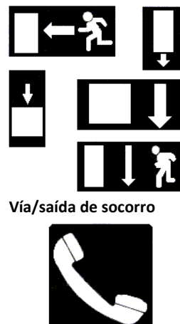
Teléfono de salvamento
