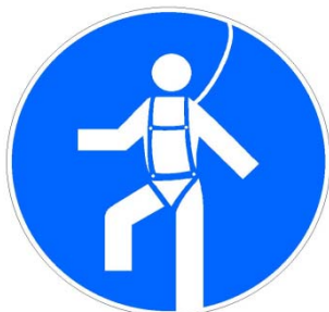
PROTECCIÓN INDIVIDUAL OBRIGATORIA CONTRA CAÍDAS
